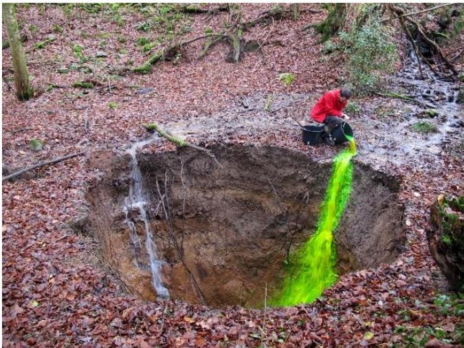
*Injection de traceur fluorescent dans une infiltration d'eau en sous-sol – photo : G. Rochez*
